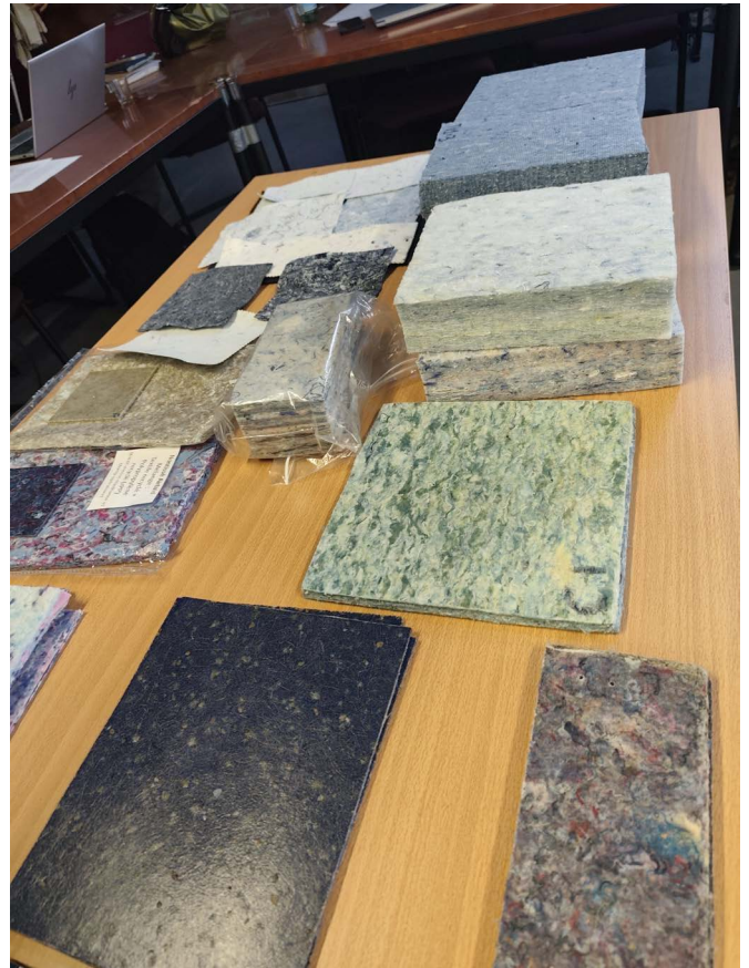
Isolants à base de textiles recyclés © Mission Bassin Minier
